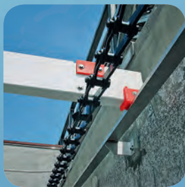
Rücklaufschiene GFR-Balken mit Gleitschuhen
